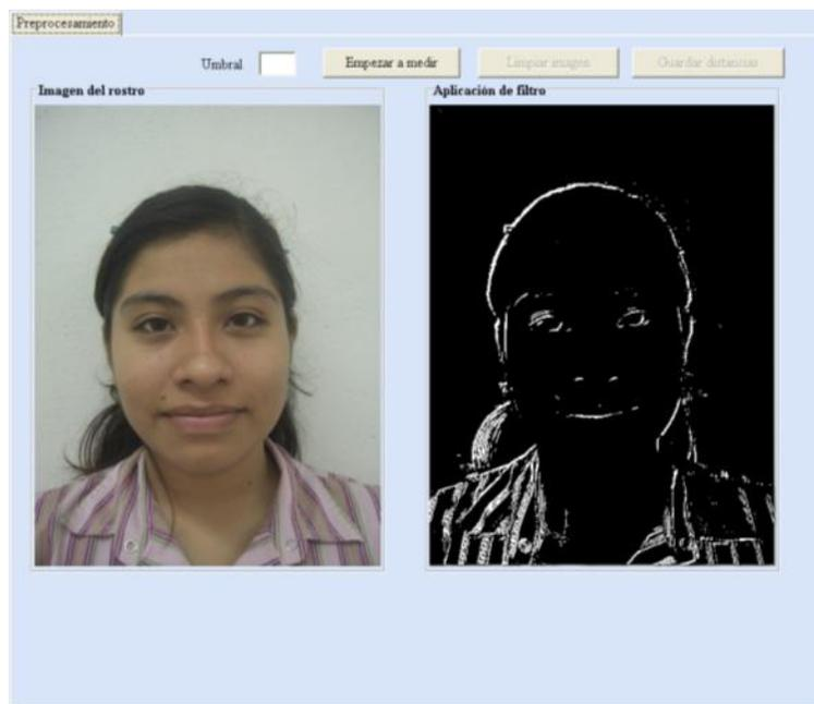
**Figura 4.22.** Aplicación del filtro de Sobel a la imagen de la figura 4.21.
