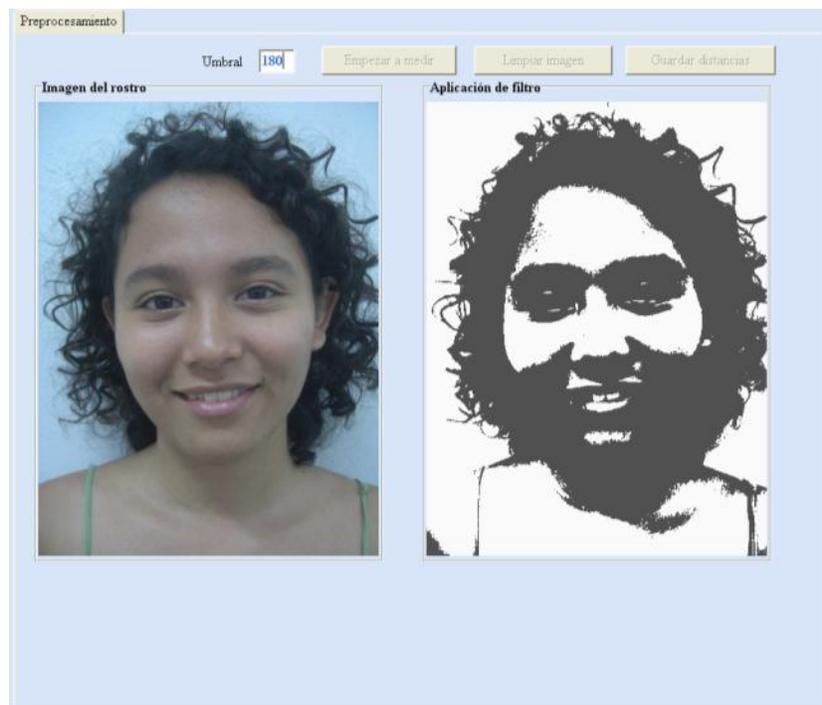
**Figura C.14.** Aplicación del algoritmo de umbralización con un valor de 180.
