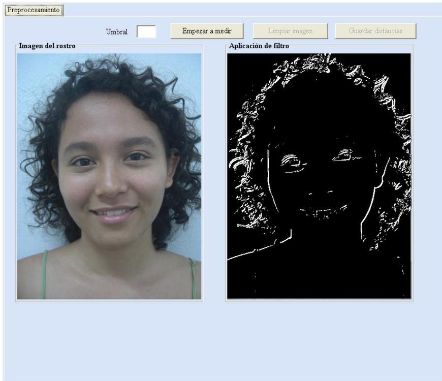
**Figura C.17.** Aplicación del filtro Sobel.
